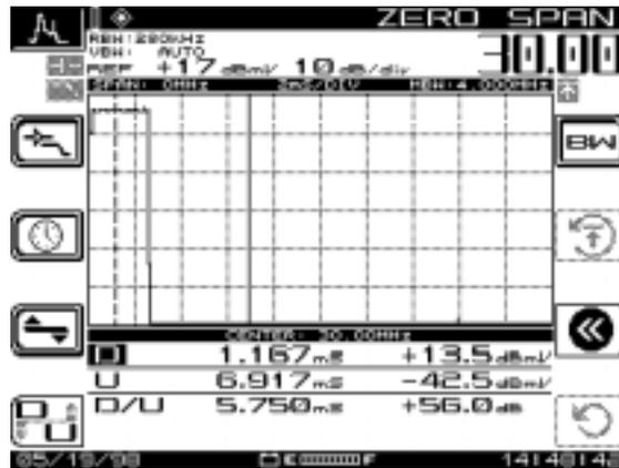
Abb. 5-5 Zeitsignal ohne Einstrahlung in der Nullspanne
